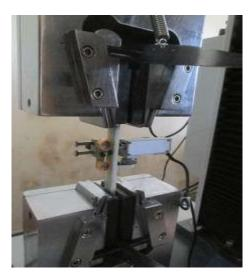
Fig 3 : - Tensile test setup
