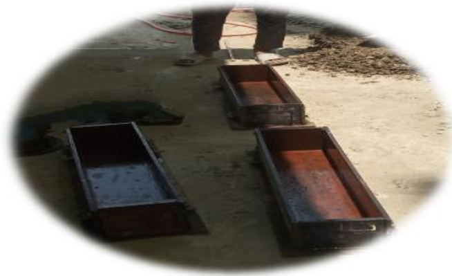
Fig: 3.3. Beam moulds
