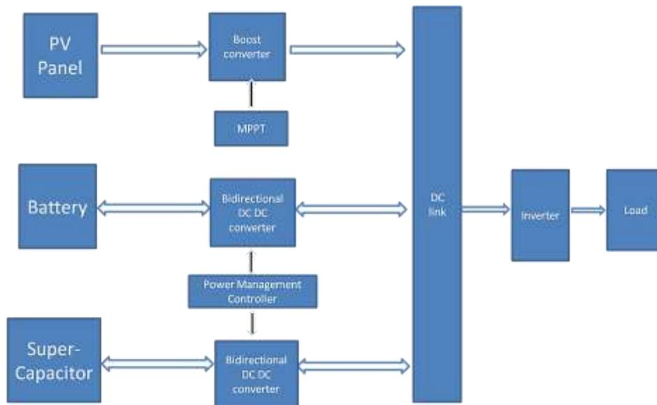
**FIG.1. BLOCK DIAGRAM FOR THE PV, BATTERY, AND SUPERCAPACITOR BASED HYBRID ENERGY STORAGE SYSTEM**
