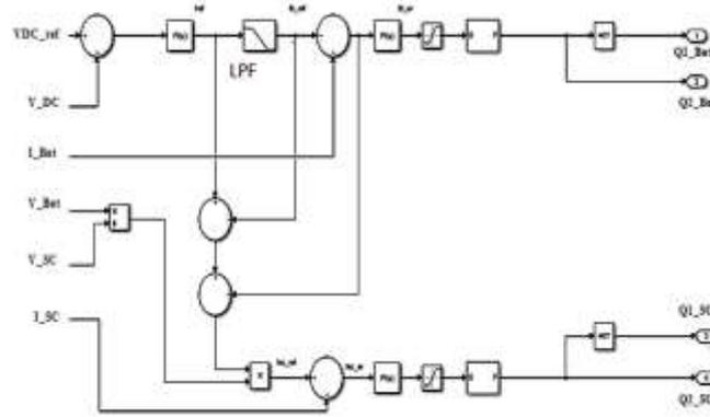
**FIG.6. CONTROL SCHEME FOR BATTERY AND SUPERCAPACITOR**
