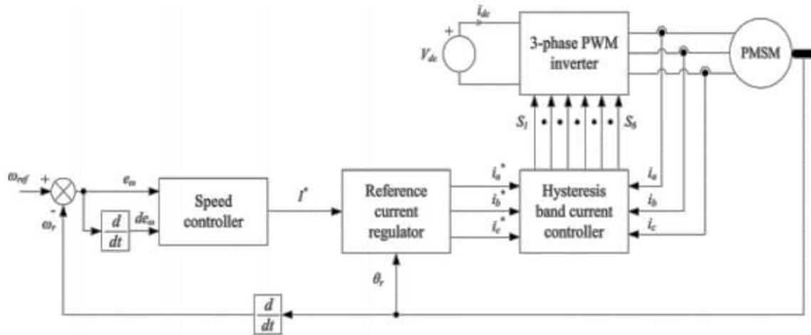
**FIG.7. BLOCK DIAGRAM OF PMSM DRIVE**
